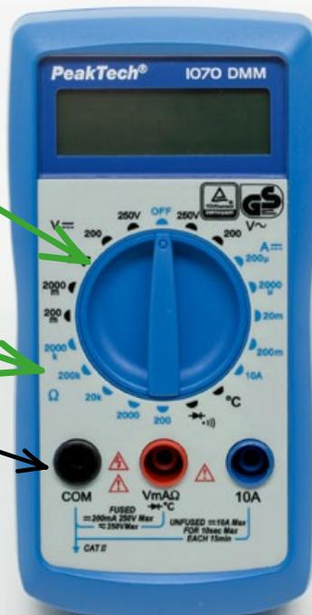
→ Miss für beide Elektroden den Widerstand zwischen der Elektrodenspitze und dem Kabelende. So lässt sich überprüfen, ob die Kabelanschlüsse funktionieren.
