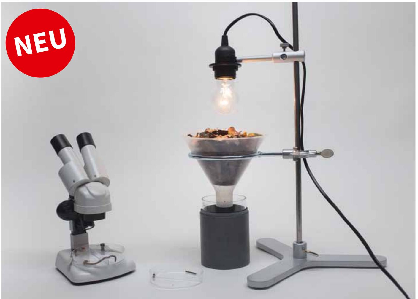
Die Berlese-Apparatur (auch als Berlese-Tullgren-Trichter bezeichnet) wurde für die biologische Untersuchung von Bodenproben entwickelt. Sie kommt vorrangig zum Einsatz, um Kleinstlebewesen (Mikroarthropoden) aus Mulch, Laub- und Nadelstreu experimentell auszusortieren.
