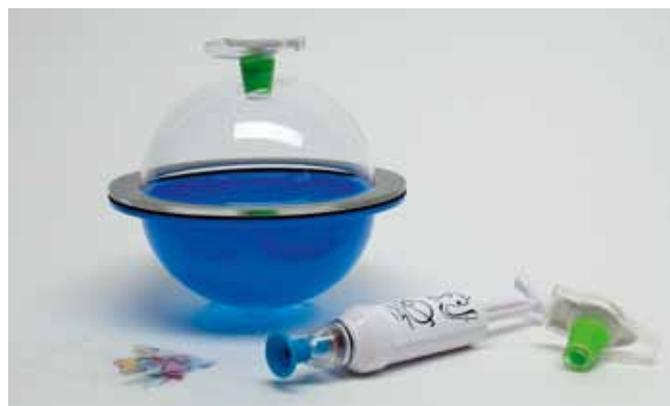
Mithilfe einer Vakuumpumpe wird die Luft aus der Raumkapsel geholt (Prinzip Magdeburger Halbkugeln).
