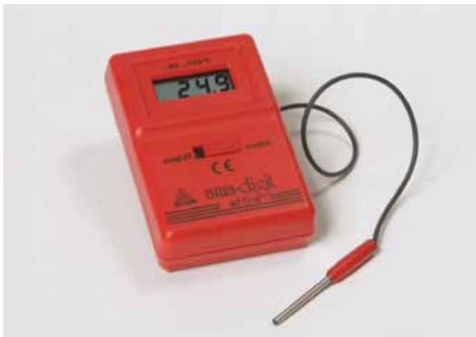
Batteriebetriebenes Gerät zum Messen in Luft, Flüssigkeiten, weichplastischen und an festen Stoffen. Kunststoffgehäuse mit  $3\frac{1}{2}$ -stelliger LCD-Anzeige, Schalter, Batteriekontrolle, Aufstellbügel und Aufhänger, Thermofühler an Kabel, einschließlich Batterie.
