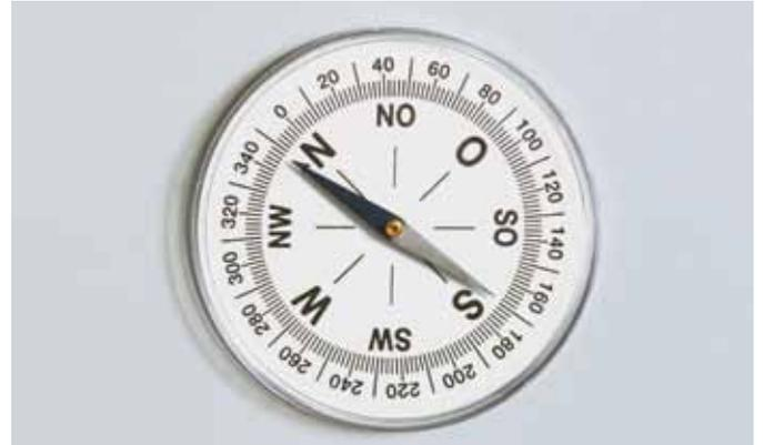
In transparentem Kunststoffgehäuse mit großer Kreisskala und Windrose, Magnetonadel mit Achatlager.
