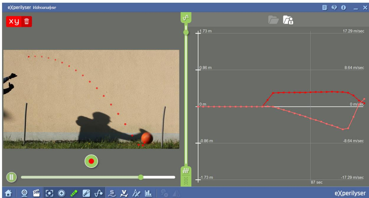
Abbildung 1 Videoanalyse eines waagerechten Wurfs mit  $t$ - $v_x$ - und  $t$ - $v_y$ -Diagramm
