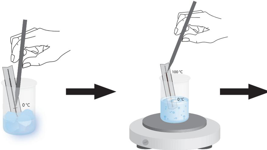
Erhitze im zweiten Becherglas Wasser, bis es siedet. Tauche das Thermometer in das siedende Wasser. Warte wieder, bis die Flüssigkeitssäule des Thermometers sich nicht mehr ändert. Markiere den Stand der Flüssigkeitssäule bei  $100^{\circ}\text{C}$ , während das Thermometer noch im Wasser ist.
